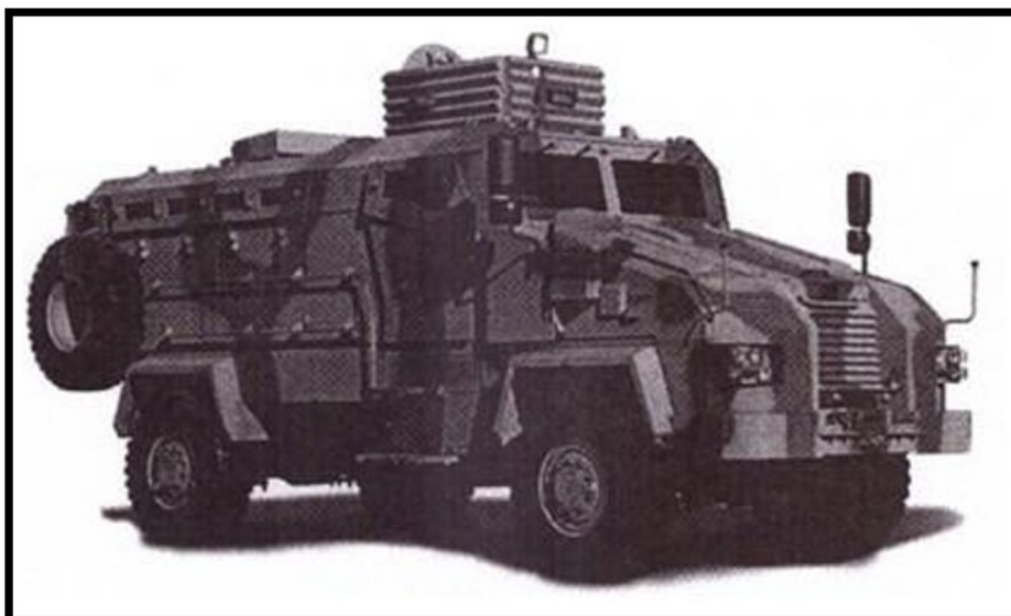
Figure 6-2 — Véhicule partiellement protégé contre les mines (MKKKA)
